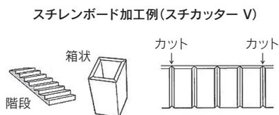
スチレンボード加工例(スチカッター V)
